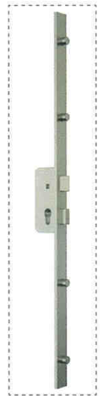
S2 ALU SERRURE MULTIPOINTS MANUELLE 4 ROULEAUX + 1 PÊNE DORMANT + 1 PÊNE DEMI-TOUR
