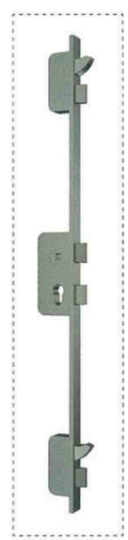
S3 ALU SERRURE MULTIPOINTS MANUELLE 2 PÊNES + 2 CROCHETS + PÊNE + PÊNE DEMI-TOUR
